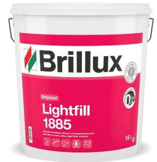
verarbeitungsfertige Leichtspachtelmasse für die Spritzverarbeitung, mit Airless- und Schneckenfördergeräten verarbeitbar, bis 5 mm Schichtdicke, konservierungsmittelfrei, weiß, für innen
